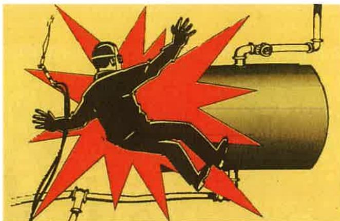
Figure 1 : explosion due à un dégazage incomplet
